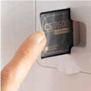
Ein falsches Einlegen der Speicherfolie wird automatisch erkannt. Darüber hinaus werden die Speicherfolien während des Vorgangs durch Hygieneschutzhüllen geschützt.
